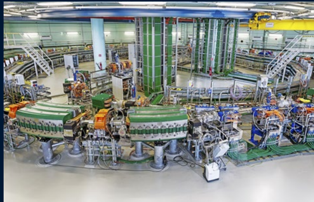
Das Synchrotron – ein kreisförmiger Beschleuniger mit ca. 80 m Umfang – stellt das Herzstück des MedAustron-Beschleunigers dar. (Credit: MedAustron)
