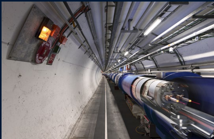
Blick auf den supraleitenden Dipolmagnet mit den beiden Strahlrohren (Credit: CERN_Fotograf Daniel Dominguez)
