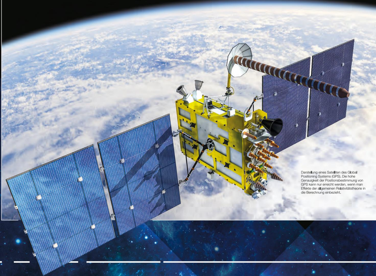
Darstellung eines Satelliten des Global Positioning Systems (GPS). Die hohe Genauigkeit der Positionsbestimmung von GPS kann nur erreicht werden, wenn man Effekte der allgemeinen Relativitätstheorie in die Berechnung einbezieht.
